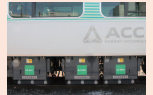
東日本旅客鉄道(株)の「EV-E301系 愛称名:ACCUM」に搭載された当社製蓄電池システム
