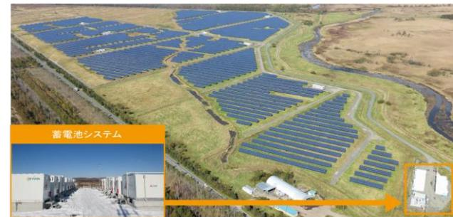
北海道 釧路町トリトウシ原野太陽光発電所のリチウムイオン電池システム
