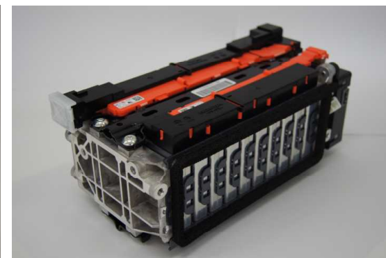
シビック ハイブリッドに 搭載されるモジュール
