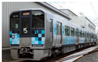
GSユアサグループの製品が採用された自己充電型バッテリー電車「Smart BEST」(近畿車輛㈱製)
