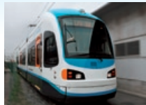
リチウムイオン電池により電線設備が要らないLRV
