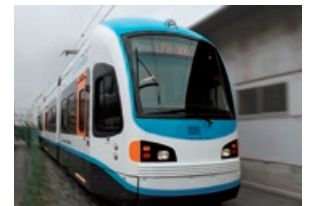
リチウムイオン電池により電線設備が要らないLRV
