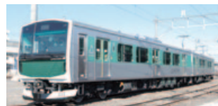
GSユアサ製蓄電池システムを搭載した蓄電池駆動電車 EV-E301系(愛称名:ACCUM(アキュム)) (画像提供:JR東日本)
